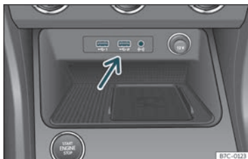
Fig. 194 Centre console: USB/AUX-IN input.
