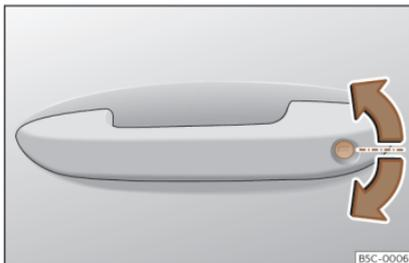
**Fig. 64** Driver door handle: locking cylinder.
